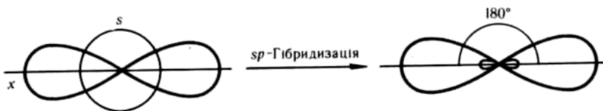
Схема утворення двох гібридних електронних хмар атома Карбону.
